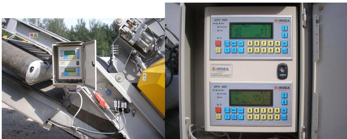
Jedna z vážících stolic před montáží na stroj RM100/OS100
