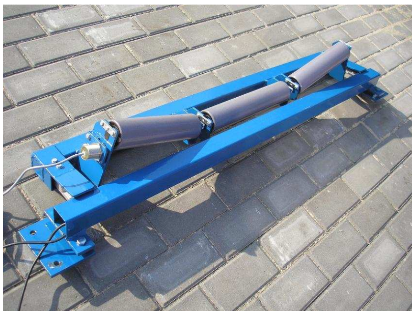
Jedna z vážících stolic před montáží na stroj RM100/OS100
