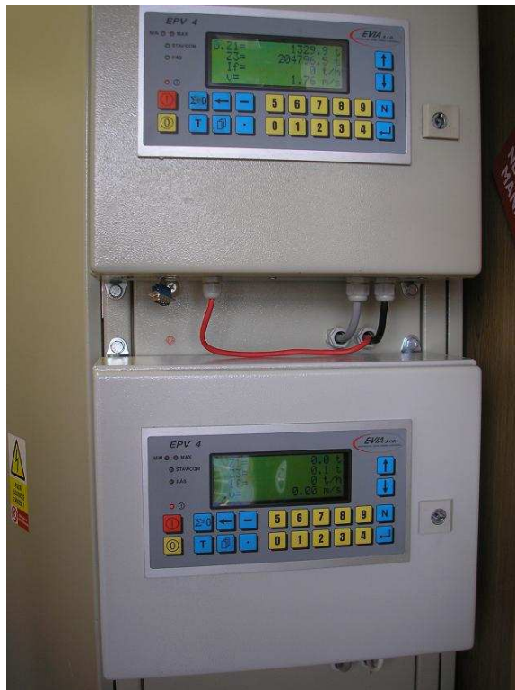
Pískovna Náklo – váha EPV s datovým přenosem do expediční kanceláře
