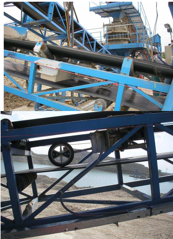
Pískovna Náklo – váha EPV s datovým přenosem do expediční kanceláře
